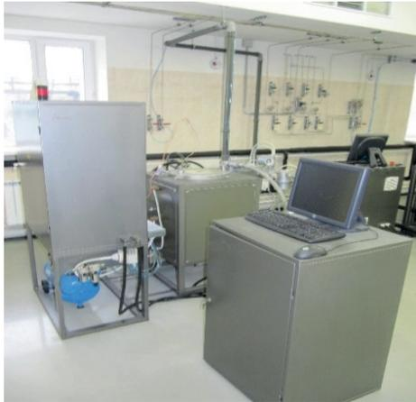
Рис. 2. Лабораторная печь ВМС-22-10,5
