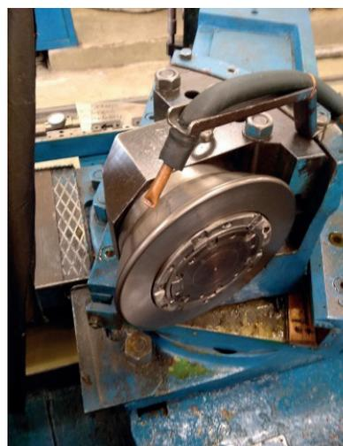
Рис. 6. Давильный ролик
