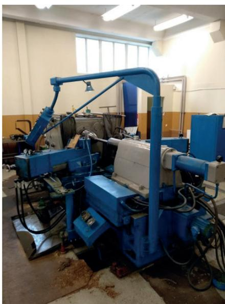
Рис. 3. Гидравлический пресс мод. RUE-160 (P=1,6 МН)
