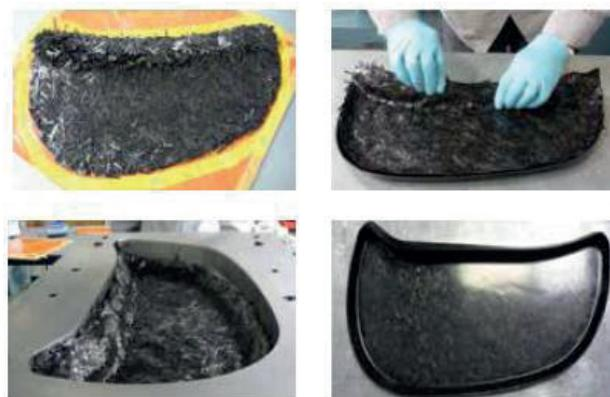
Рис. 15. Формование заготовки в пресс-форме
