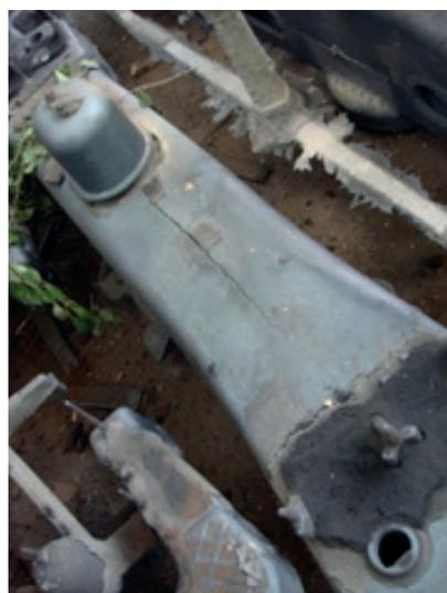
Рис. 1. Балка надressорная с горячей трещиной по верхнему поясу
