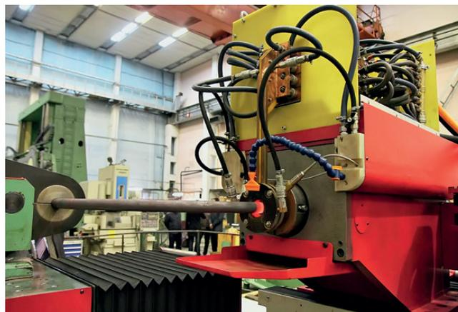
Рис. 2. Гибка с труб с узкозональным индукционным нагревом на станке СГИН-120
